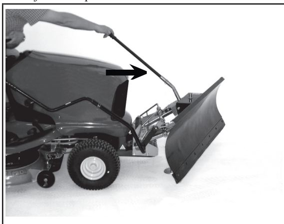
3) Zdvihněte ovládací tyč a otočte radlici do požadované polohy.
