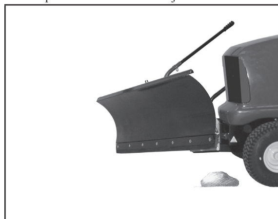
4) Otočené zařízení se uvolní a radlice se vyhne překážce.
